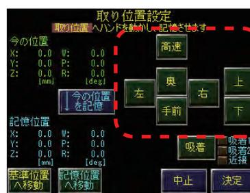
画面上のボタンでロボットを動かし実際の動作を見ながら位置を記憶させる事ができます
