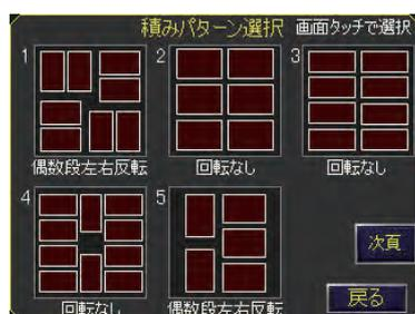
箱の取り位置や置き位置などロボットが動作する上で品種ごとに調整が必要な位置もタッチパネルから変更できます
