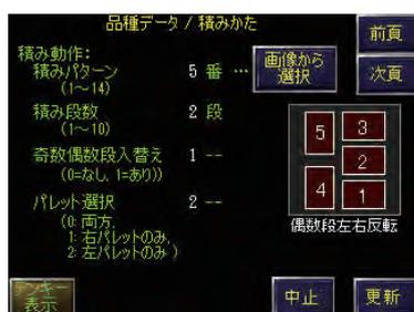
箱のLWH寸法を入力して積み付けパターンを選ぶだけで新品种も簡単に積付ける事ができます
