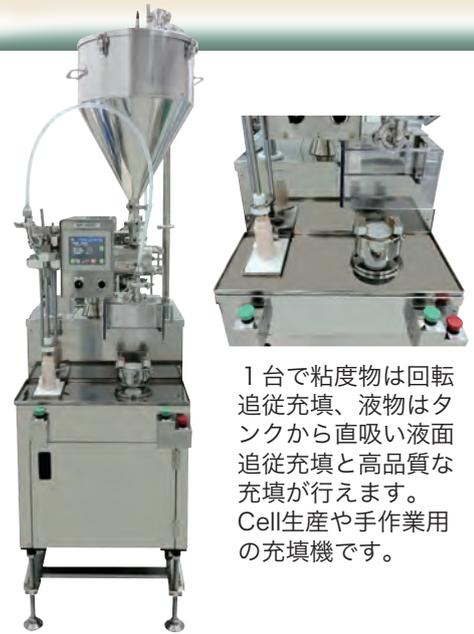
1台で粘度物は回転追従充填、液物はタンクから直吸い液面追従充填と高品質な充填が行えます。Cell生産や手作業用の充填機です。
